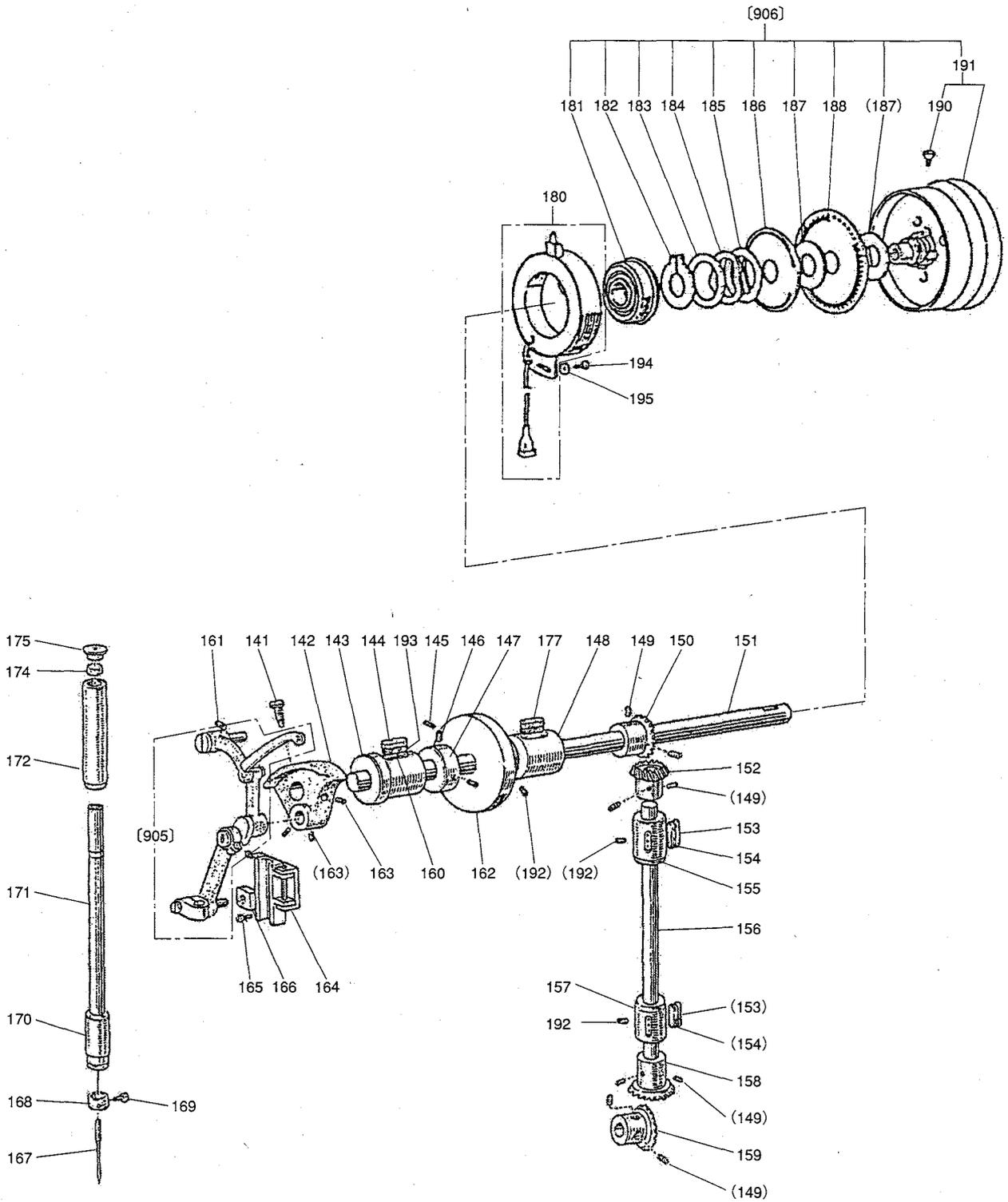
[E]上軸・堅軸・天ビン・針棒機構
